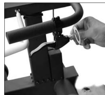
手順 4 ロックナットを締め、 遊びを調節します。
