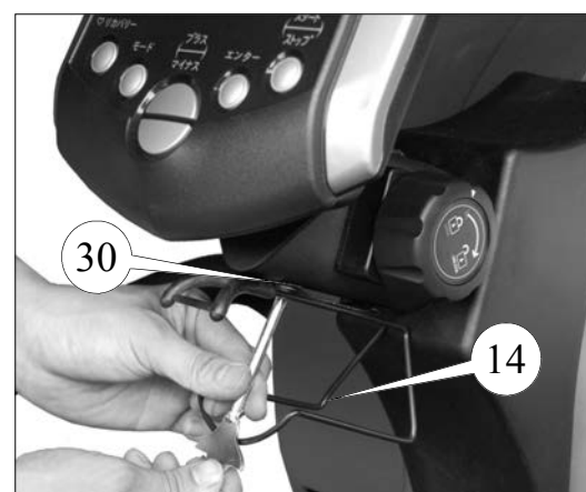
手順 3 ロックナットをワイヤーに付け、 レバー横の溝にワイヤーを通す。
