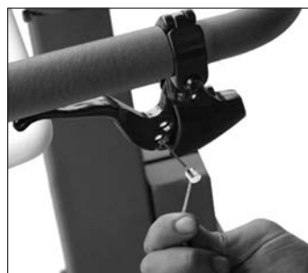
手順 2 ワイヤー先端をレバー横にある 穴に差し込む。
