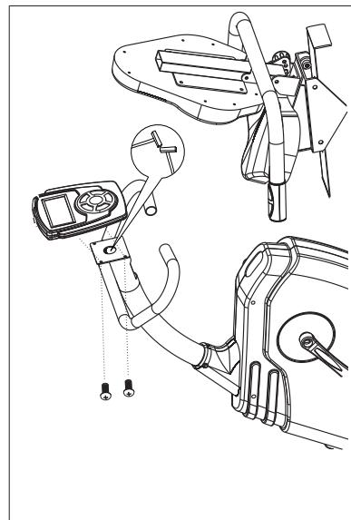
コンピューター裏側に乾電池を2本入れ取付用ビス4本（M5-10mm）を外してください。
