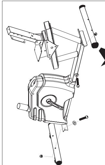
バーナリストNo.10前脚・No.11後脚のボルト（M8-75mm）
