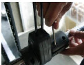
2 1個のプラスチックロックングスリーブ (部品39)をセンサーウエイトバー (部品25)の各端部に置き、それがウエイトバーケーブルナックルにつきあたるまで滑らせて、そのケーブルナックルを所定位置に固定させる。次にプラスチックロックングスリーブのボルトを締め付ける。
