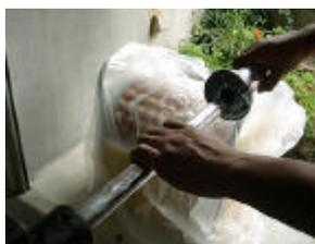
3 オリンピックアダプター (部品30)の1つをセンサーウエイトバー (部品25)に差し込みプラスチックロックングスリーブ (部品39)に触れるまで入れる。次にセンサーウエイトバー (部品25)の端にオリンピックアダプター (部品30)をはめ込む。最後に2本のアレンボルト (部品29)と2枚のワッシャー (部品36)で固定する。
