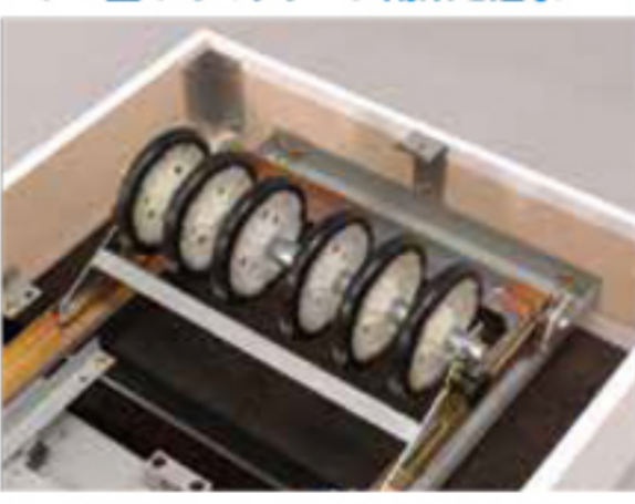
ローラーは上部6個、下部6個、計12個が内蔵されています。
